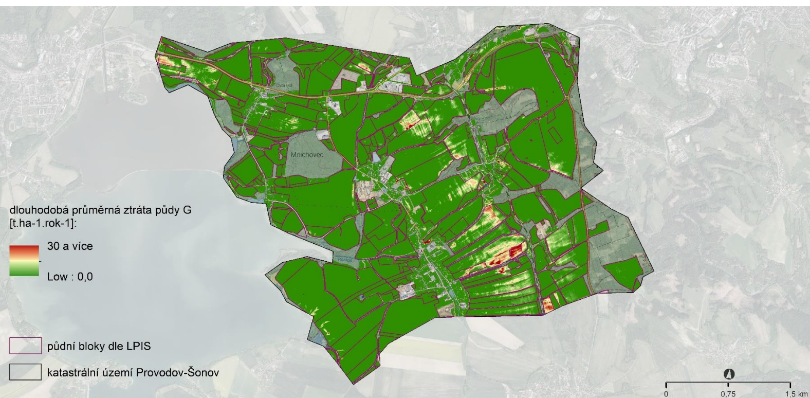
Obr. č. 21: Dlouhodobá průměrná ztráta půdy způsobena vodní erozí, výpočet ztráty půdy s využitím faktoru erozní účinnosti deště R = 40 \text{ MJ} \cdot \text{ha}^{-1} \cdot \text{cm} \cdot \text{h}^{-1}
