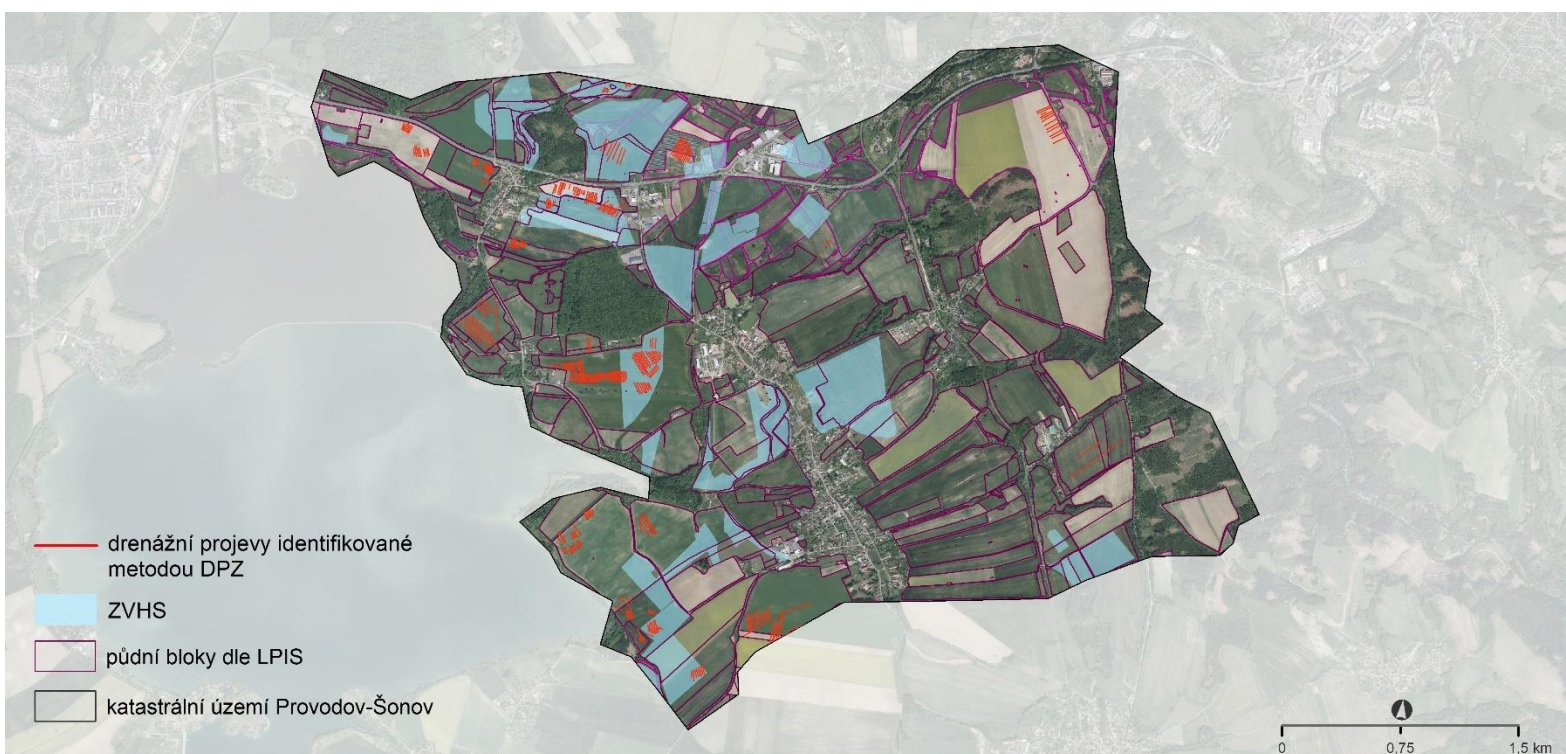
Obr. č. 44: Identifikované projevy drenážní stavby pomocí DPZ v porovnání s vrstvou ZVHS
