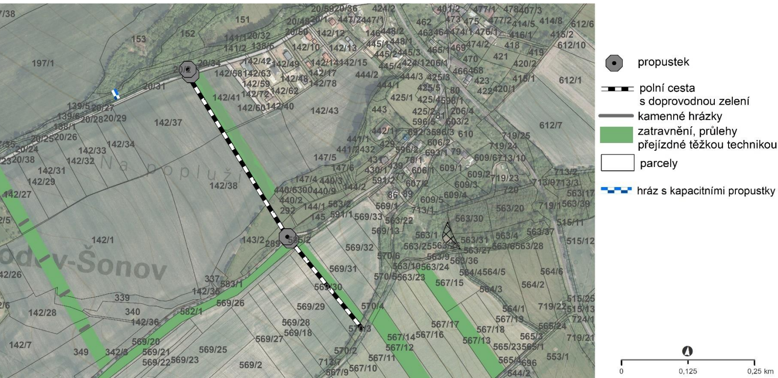
Obr. č. 24: Rámcový návrh polní cesty v oblasti povodí KB04 a KB05
